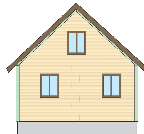
Рис. 33. Смещение «нахлестов» на сайдинговой обшивке
